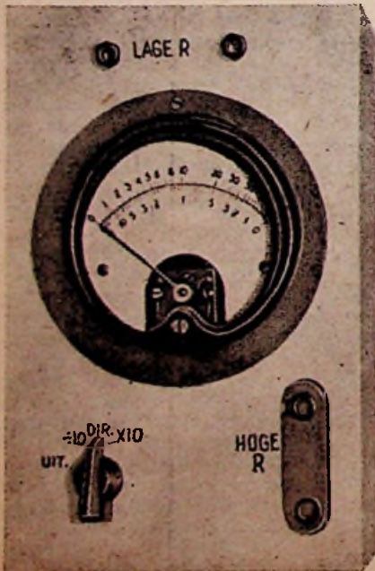
Fig. 5. De schaal van het instrument. Lage weerstanden, gemeten volgens de shunt-methode worden boven af-
